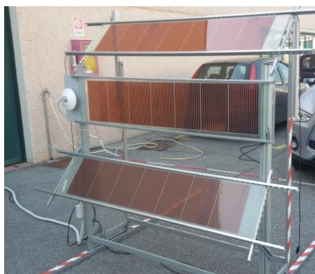
Figura 1: sun-test di pannelli n-DSC
